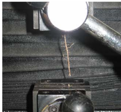
شکل ۲- گسیختگی از محل نزدیک به فک (احتمال تاثیر تنش حاصل از فشار لبه های فک)
