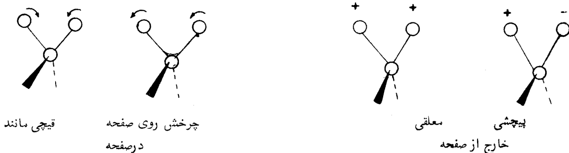
شکل (۲) لرزشهای مربوط به تغییر شکل زاویه ای*
