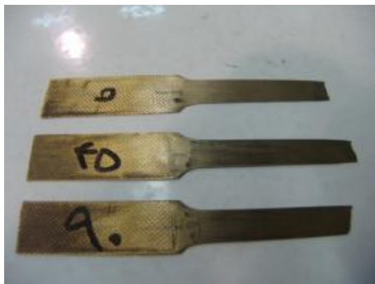
شکل ۲: نمونه‌های حاصل از آزمایش کشش.
