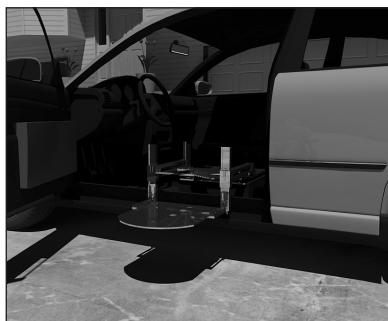
تصویر ۱۸- سیستم چهارمیله ای که در این پروژه برای خودروی سمند طراحی شده است. ماخذ: (نگارندگان)
