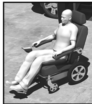
تصویر ۱۵- ویلچر مخصوص خودروی سمند که در این پروژه طراحی کرده ایم. ماخذ: (نگارندگان)
