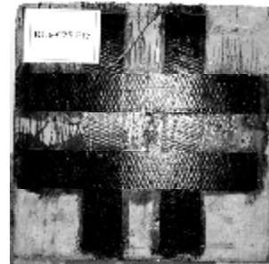
شکل ۱: جزئیات نمونه‌های آزمایشگاهی و ورق‌های CFRP.
