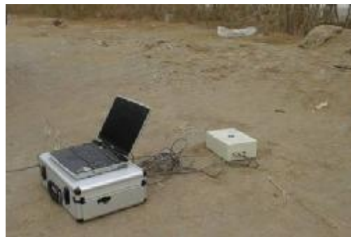
شکل ۲: دستگاه ثبت میکروترمو به همراه سایر تجهیزات.
