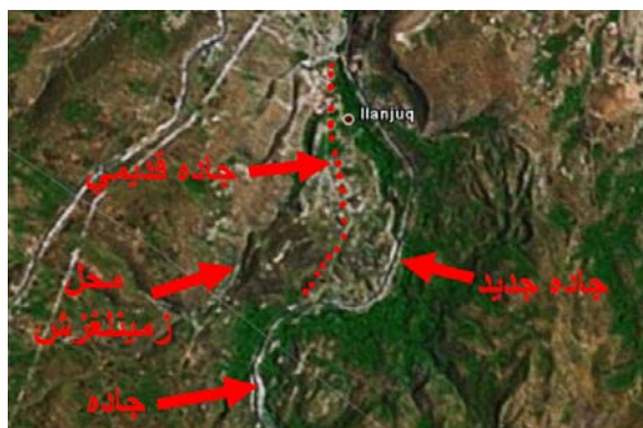
شکل ۴. عکس ماهواره‌ای منطقه. تاثیر وقوع زمین لغزش بر تغییر مسیر جاده به وضوح مشخص است (Google Earth).
