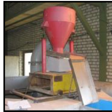
شکل ۹: تصویر دستگاه رسوب‌ریز. 1.0E+00
