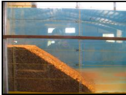
شکل ۱۰: تصویر پیشروی زبانه رسوبی در فلوم (دید از سمت جداره شیشه‌ای).
