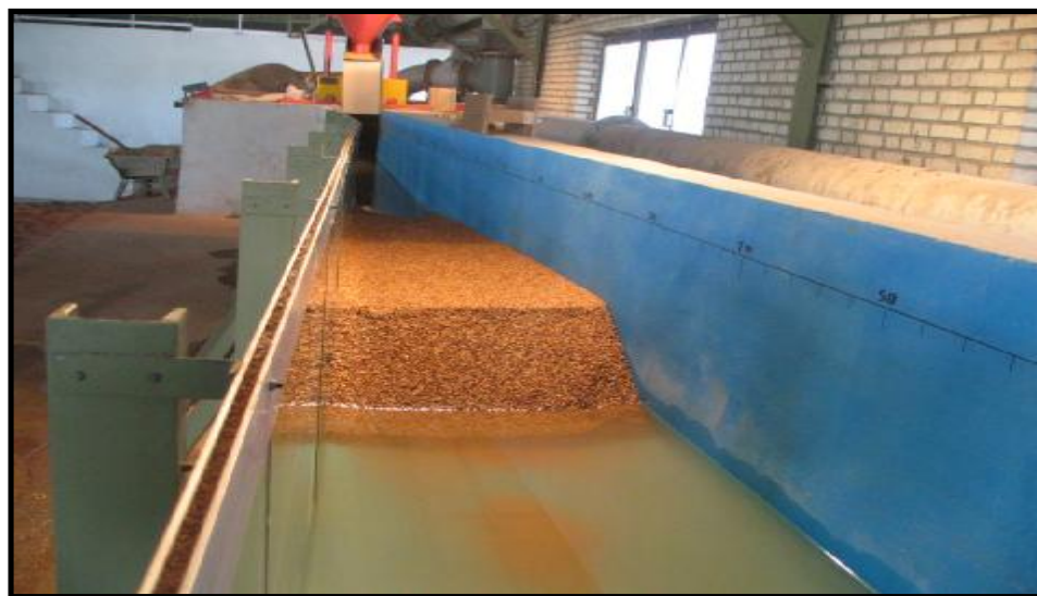
شکل ۱۲: تصویر جسم کامل دلتای رسوبی در فلوم (نمای روبرو).
