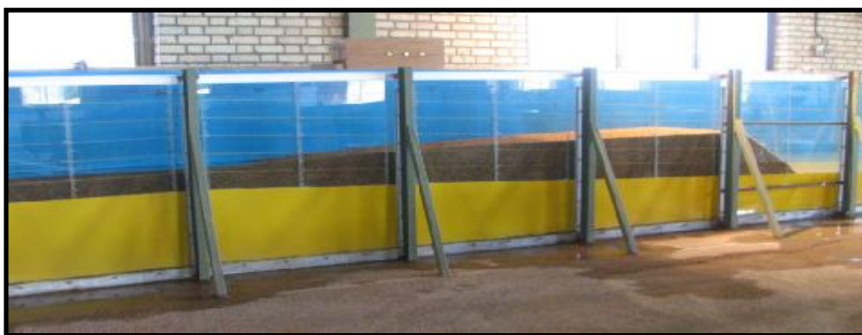
شکل ۱۱: تصویر جسم کامل دلتای رسوبی در فلوم (نمای جانبی).
