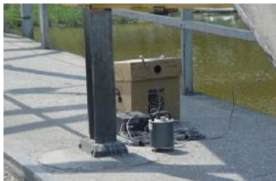
شکل ۶: سرعت سنج CMG_6TD و چگونگی نصب آن روی عرشه پل.
