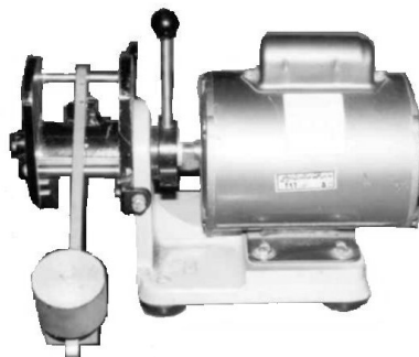
شکل ۱- سفیدکن آزمایشگاهی مالشی Mc Gill Miller, Satake Engineering, Co., Tokyo (Japan, 1998)
