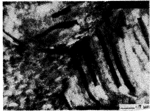
شکل ۱۶: ساختار میکروسکوپی از شمش پیرشده در دمای 100^{\circ}\text{C} به مدت ۱۶۸۰ دقیقه، نشان دهنده مرزهای ما بین سه دانه و رشد فازی به صورت صفحه ای و یا گلوله ای شکل میدان روشن.
