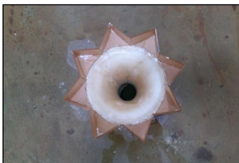
شکل ۴. سرریز نیلوفری با مقطع دایره با تعداد هشت زیگزاگ
