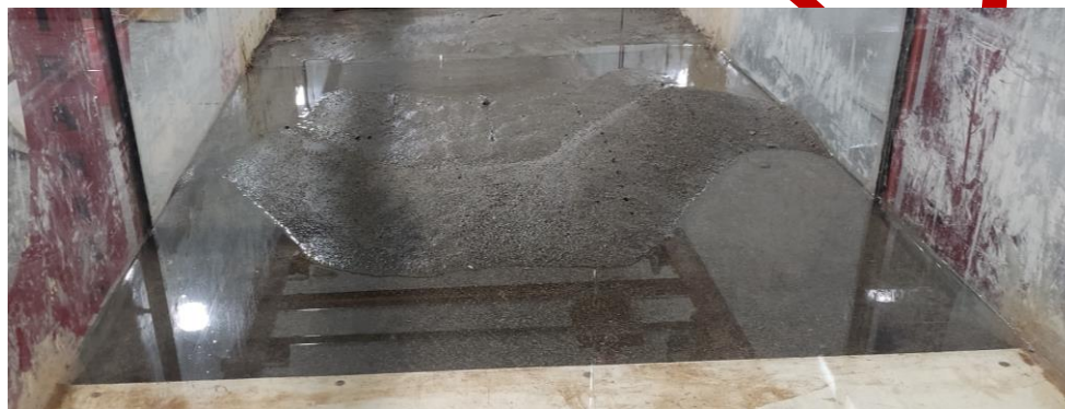
شکل ۱۸. نمایی از بستر رسوبی با دانه‌بندی S1 و درصد رس ۱۵ درصد پس از اتمام آزمایش
