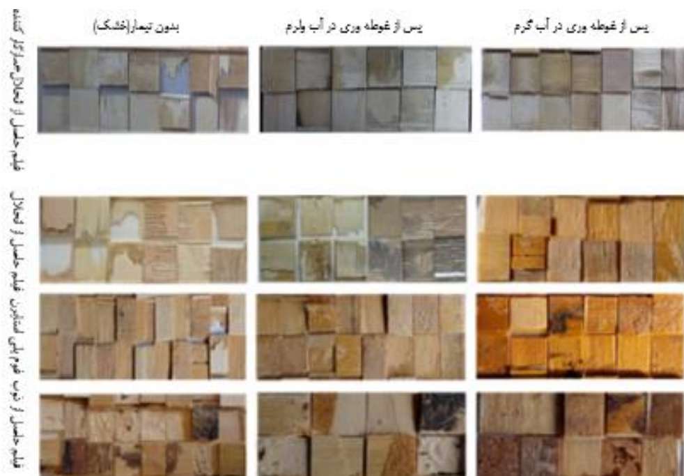
شکل ۳. سطح شکست نمونه‌ها بعد از آزمون مقاومت برشی تخته‌لایه‌های ساخته شده با اشکال مختلف پلی‌استایرن به‌عنوان چسب
