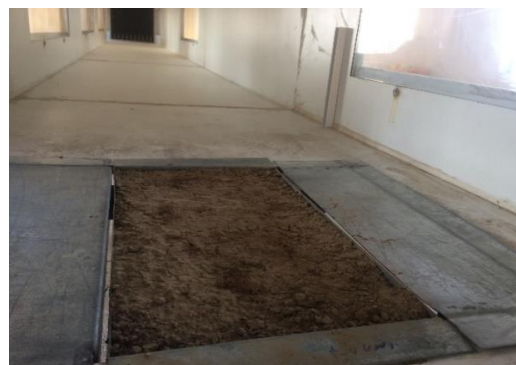
شکل ۲. نمایی از تونل باد مورد استفاده در تحقیق، توزین نمونه خاک در آزمایشگاه تونل باد و قرارگیری سینی آزمایش در محفظه آزمایش تونل باد
