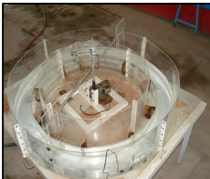
شکل ۱. پلان و تصویری از فلوم دایره‌ای مورد استفاده برای انجام آزمایشات
